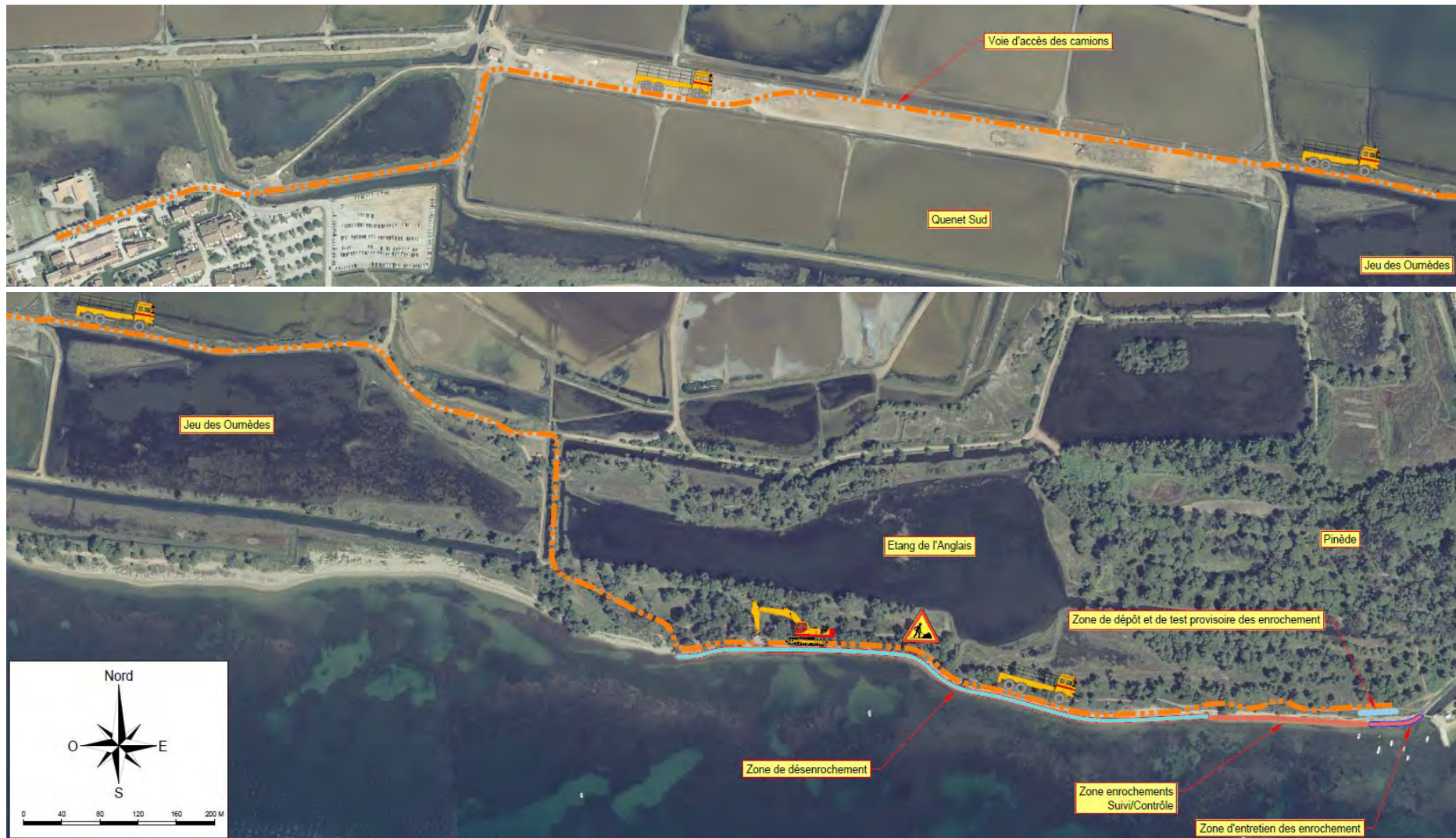
Fig. 16. Emprise des travaux de suppression et entretien des enrochements
