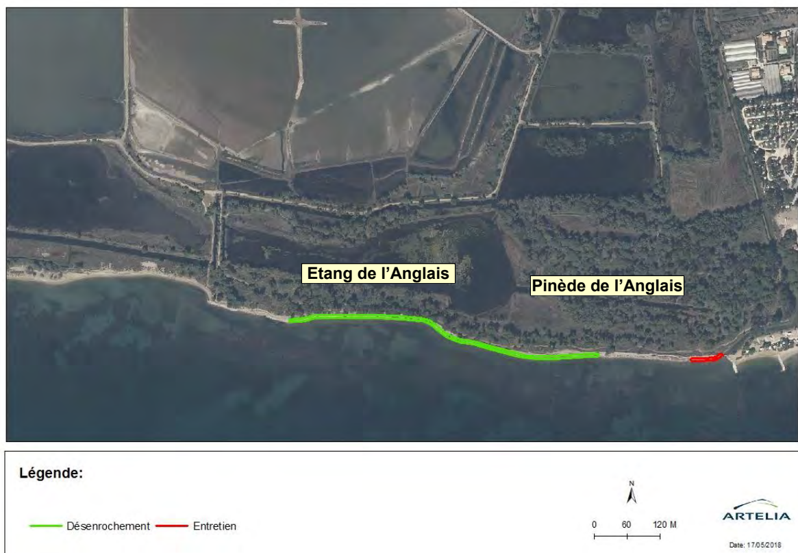
Fig. 10. Carte de localisation des zones de suppression et d'entretien des enrochements
