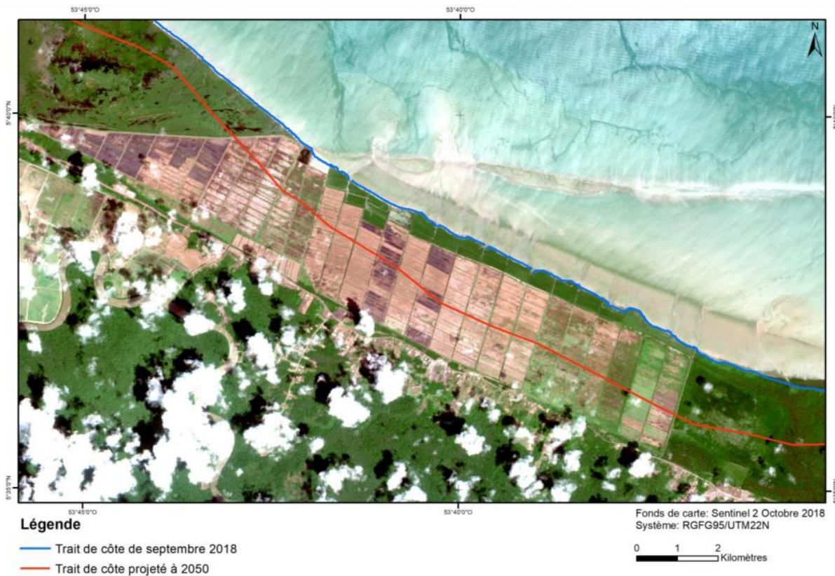
Figure 17 : Projection de la position du trait de côte à 2050 (trait rouge). Le trait de côte de référence de septembre 2018 est figuré en bleu.
