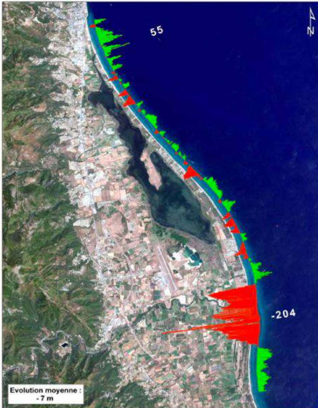
Illustration 19 - Evolution du trait de côte 1937-2013 du littoral de la Marana et de la Casinca
